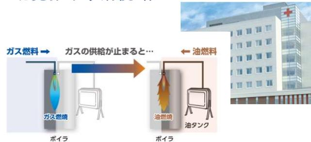
オホーツク圏唯一の救命救急センターを有する病院で、暖房・殺菌などの用途でボイラを使用いただいています。災害時など都市ガスが止まってしまった有事に備え、貯蔵している油燃料に切り替えが出来る切替専焼仕様ボイラを提案し、地域医療の安心に貢献しています。
