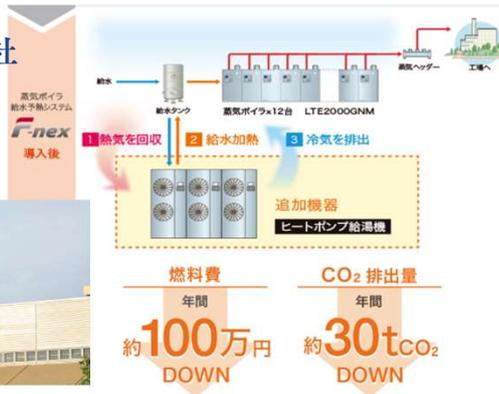
ビールの原料となる麦や米を煮沸させる熱源である、蒸気ボイラについて省エネとボイラ室内の熱気を抑えるなど作業環境の改善が課題でした。室内の熱気をヒートポンプで回収してボイラの給水温度を上げる「F-nex」の提案で、最大限の省エネ効果の実現・作業環境の改善にもつながりました。
